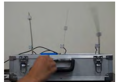
手回し携帯振動台（ふるる）を用いた固有周期に関する学習の様子
