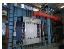
鉄筋コンクリート造構造壁 の構造実験
