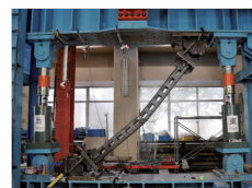
高強度鋼と低降伏点鋼を併用 した安価な制振部材の開発
