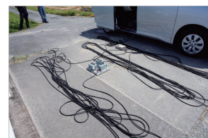
常時微動による地盤振動の計測
